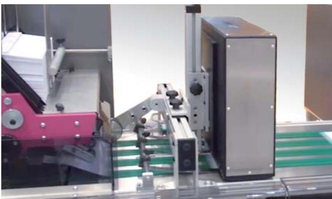
Vakuumband an der Gutzuführung
