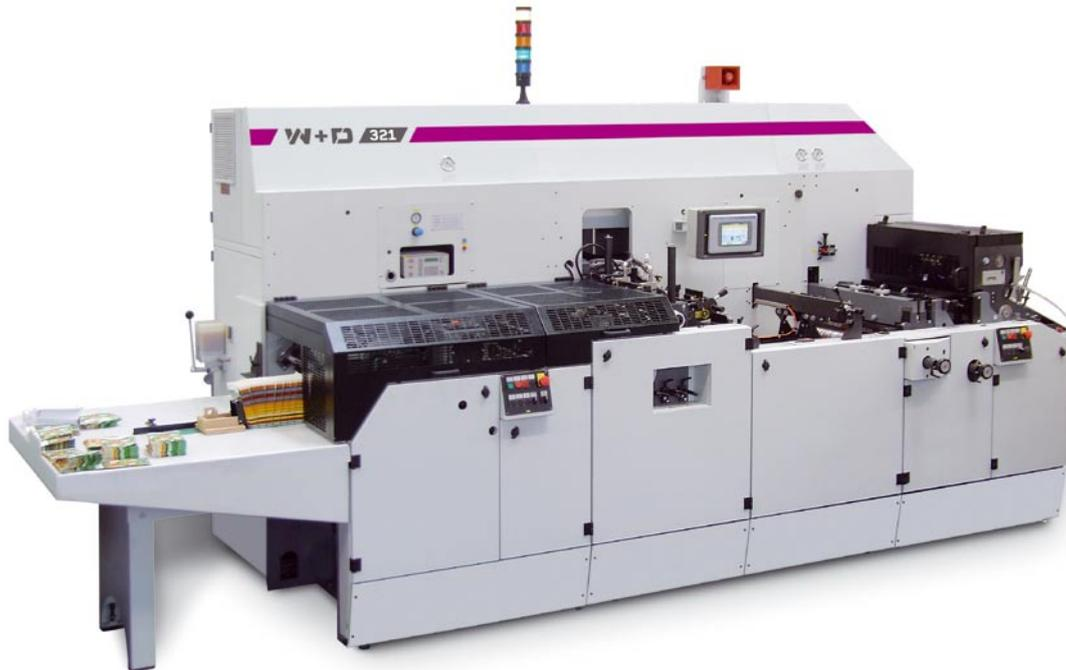
Das Produktionssystem **W+D 321** ist die perfekte Lösung zur Herstellung von 2-Naht-Samenbeuteln. Die Maschine verfügt über einen universellen Formatbereich, der über die Ansprüche des Marktes hinausgeht. Mit einer Leistung von bis zu 400 Produkten pro Minute bietet die **W+D 321** eine besonders hohe Produktivität.
